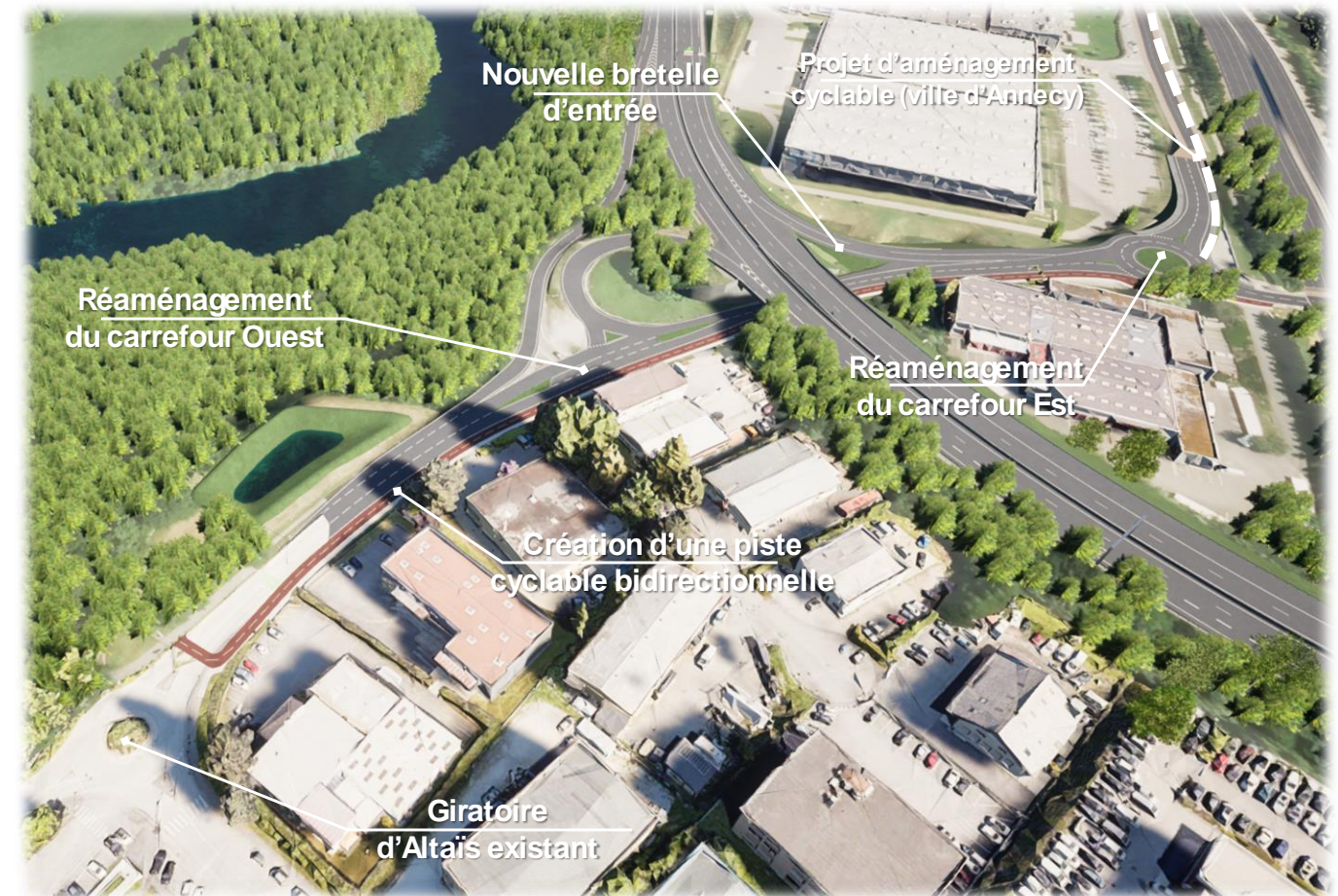
Diffuseur Route de la Salle
